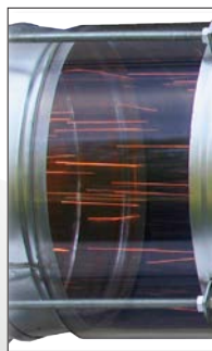
Sichtbare Funken beim Eintritt in den Funkenabscheider (vergrößerte Darstellung, unten)
